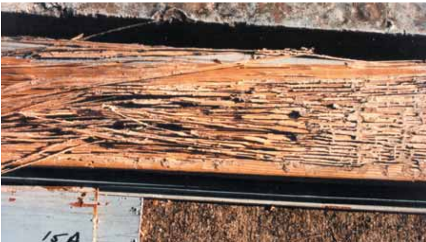
Fig. 1. Las termitas subterráneas excavan galerías en la madera al consumirla, algunas veces dejando nada más que una capa exterior fina. (B. T. Forschler)
